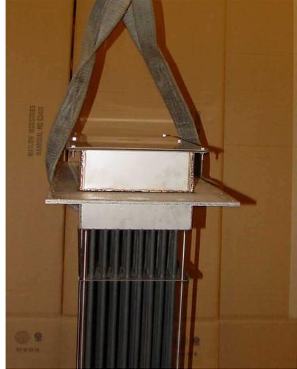
**Figura n.º 4: Para izado vertical, coloque la correa a través del espacio entre el conjunto de elementos y la pieza de retención de aislamiento. No deslice la correa por entre los elementos.**
