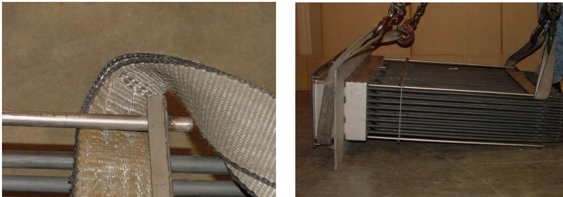
**Figura n.º 3: Instalación de correa de izado entre el conjunto de elementos y el soporte de montaje. No entrelace las correas entre los elementos. Coloque la segunda correa alrededor de la caja de terminales.**
