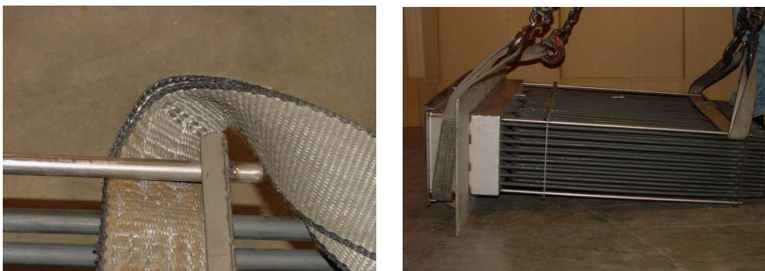
Figure 3 : installez les sangles de levage entre le faisceau de tubes de l'élément et la tige de support. N'enchevêtrez pas les sangles dans les éléments. Placez la deuxième sangle autour du boîtier de la borne.
