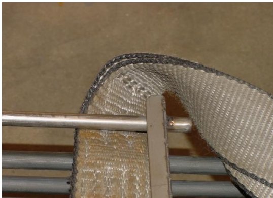
Figura n.º 3: Instalación de correa de izado entre el conjunto de elementos y el soporte de montaje. No entrelace las correas entre los elementos. Coloque la segunda correa alrededor de la caja de terminales.
