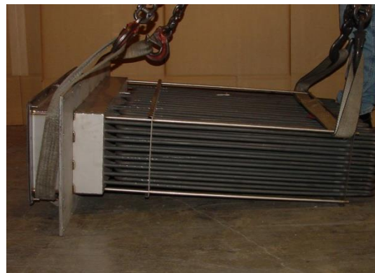
Figura n.º 3: Instalación de correa de izado entre el conjunto de elementos y el soporte de montaje. No entrelace las correas entre los elementos. Coloque la segunda correa alrededor de la caja de terminales.
